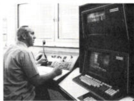
Afb. 10b. De centrale van NIAG kan steeds contact opnemen met de autobussen. Binnenkomende meldingen van alle buslijnen worden door de computer verwerkt.
