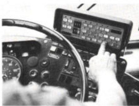
Afb. 10a. Gebruikmakend van het Teletrans-systeem kunnen buschauffeurs van de vervoersonderneming NIAG in Moers (BRD) door een druk-op-de-knop op elk moment contact opnemen met de centrale.
